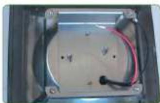
Adesso possiamo installare il nuovo vano portacablaggio, innestandogli dal basso il gruppo LED tramite i due perni e fissandolo con altre 2 viti dall'alto. Bloccare l'alimentatore con la cavalletta con altri 2 dadi M5. Collegare i cavi del gruppo all'alimentatore, e la linea al morsetto rispettando F-N.
